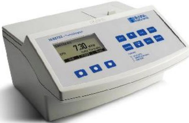
Ce nouveau turbidimètre représente la solution idéale pour analyses des échantillons colorés.
